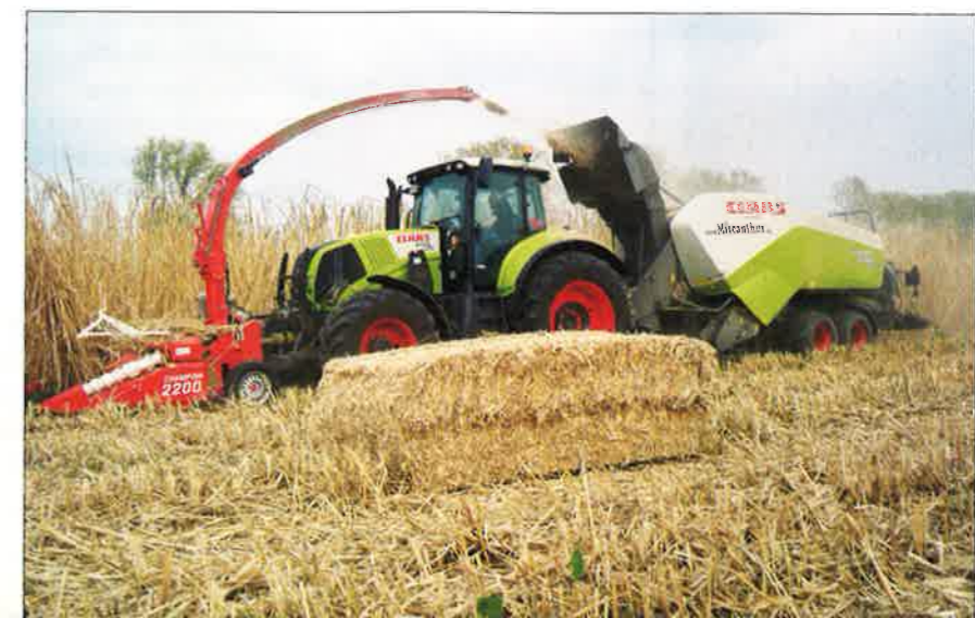
Feldarbeit: Für den Transport zum Heizkessel wird der geerntete Miscanthus in Ballen gepackt.
