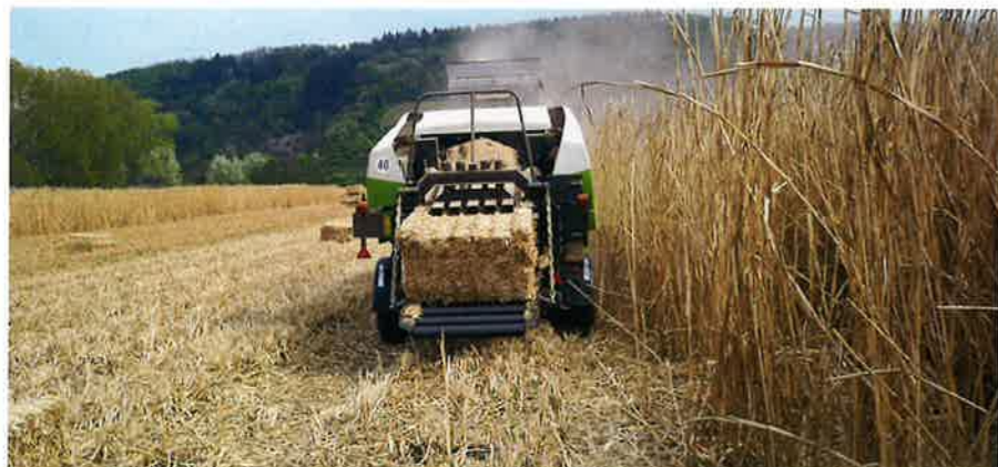
Miscanthus-Häckselgut in Ballen zu pressen und zu binden, ist nicht ganz einfach, denn bei kurzer Häcksellänge sind sie nicht so stabil wie Stroh- oder Heuballen.
