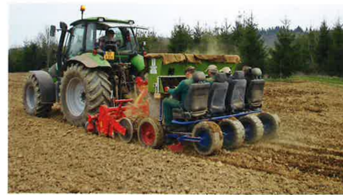
Mit der von Luc Feinen selbst konstruierten Pflanzmaschine werden die Miscanthus-Rhizome gepflanzt. Vier Personen lassen dazu im Takt Wurzelstücke durch Rohre fallen. Die Maschine ist mit einem Bodenbearbeitungsgerät kombinierbar.
