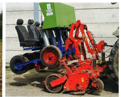
Mit der von Luc Feinen selbst konstruierten Pflanzmaschine werden die Miscanthus-Rhizome gepflanzt. Vier Personen lassen dazu im Takt Wurzelstücke durch Rohre fallen. Die Maschine ist mit einem Bodenbearbeitungsgerät kombinierbar.
